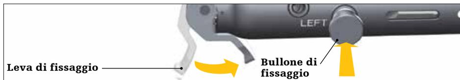
visibile nella finestra dell'indicatore di allineamento (Fig. 113). Inserire completamente il bullone di fissaggio dall'apertura laterale, finché non scatta in posizione. La leva di fissaggio deve essere poi bloccata saldamente. Fare riferimento alla Fig. 114.
